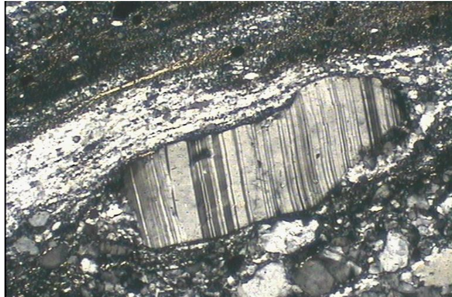
斜长石的S型残斑结构, 双晶弯曲变形; 糜棱结构
