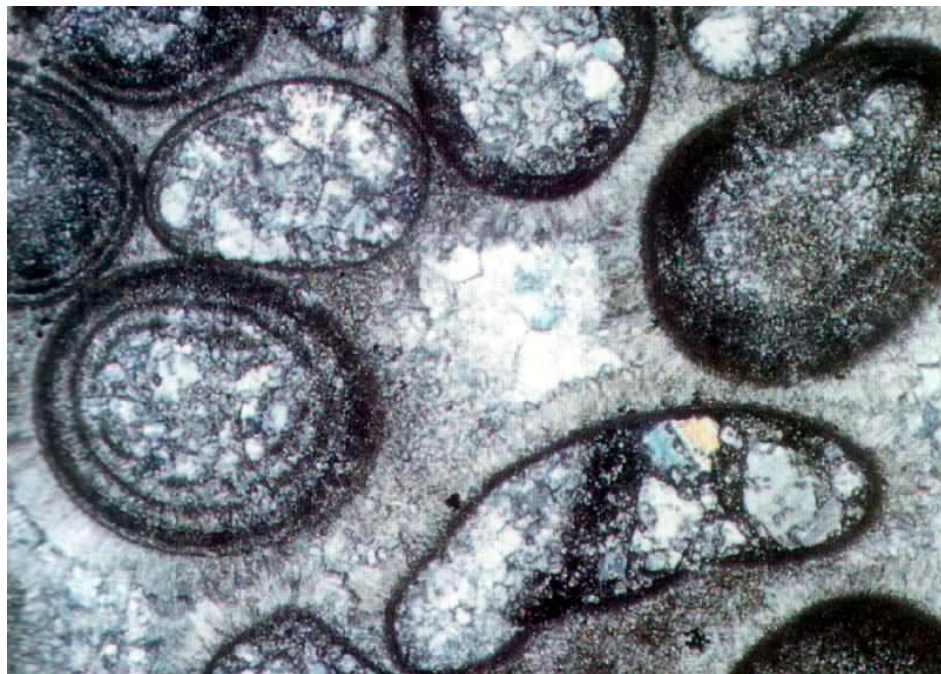
亮晶鲕粒石灰岩，方解石充填负 鲕粒，粒缘为纤维状方解石胶结
