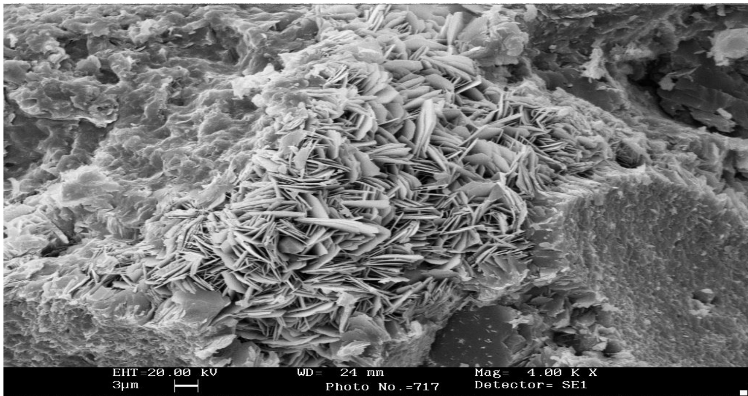
沙1井， 5452.34m ， T1b ， 粒间针叶状绿泥石 ， 放大倍数4000
