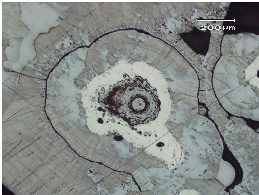
胶状构造的针铁矿与纤铁矿
