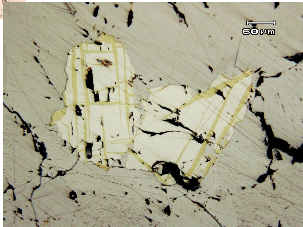
镍黄铁矿中出溶的格状黄铜矿
